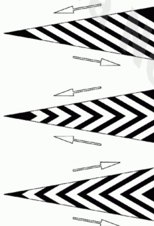
Spații interzise circulației
