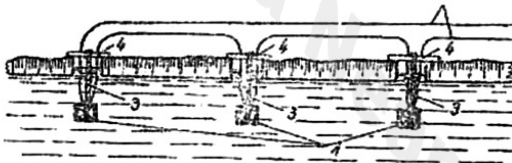
Figura nr. 11. Distrugerea gheții cu un grup de încărcături concentrate
