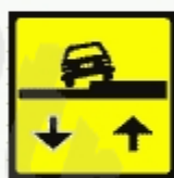
Denivelare față de banda alăturată
