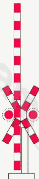
Trecere la nivel cu o cale ferată simplă cu semibariere, prevăzută cu semnale luminoase de avertizare a apropiării trenului
