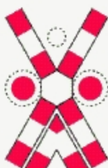
Trecere la nivel cu o cale ferată dublă, fără bariere, prevăzută cu semnale luminoase de avertizare a apropiării trenului
