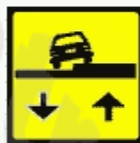
Denivelare față de banda alăturată
