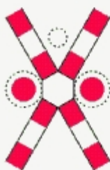
Trecere la nivel cu o cale ferată simplă, fără bariere, prevăzută cu semnale luminoase de avertizare a apropiării trenului
