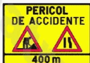
Presemnalizarea unui sector cu circulație alternantă
