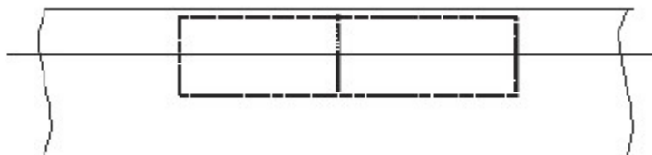
Figura 6.1 - Orientarea epruvetei utilizată la încercarea metalului de bază
