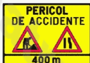
Presemnalizarea unui sector cu circulație alternantă
