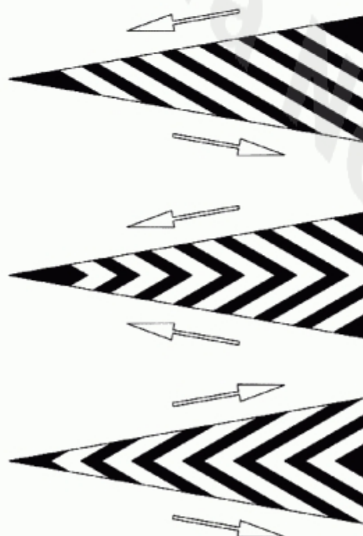
Spații interzise circulației
