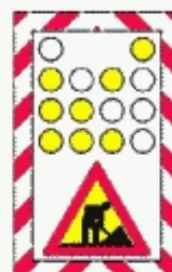
Semnalizarea unui utilaj care se deplasează lucrând
