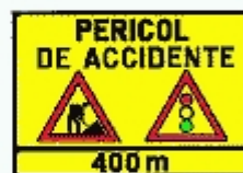
Presemnalizarea unui sector cu circulație alternantă
