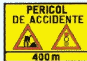
Presemnalizarea unui sector cu circulație alternantă
