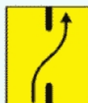
Terminarea abaterii temporare
