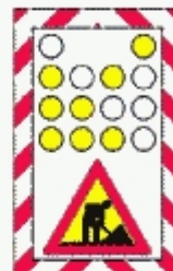
Semnalizarea unui utilaj care se deplasează lucrând
